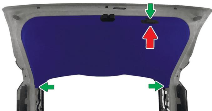
**3** Пластиковым **съемником** обивок подденьте и **снимите** камеру заднего вида. Отсоедините разъем камеры.
