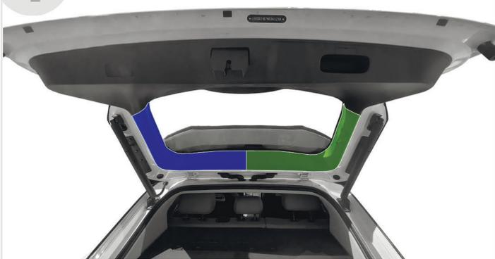
**2** Снимите **заглушку** в ручке закрывания багажника, выверните **3 самореза** PH2 и снимите **нижнюю наклейку** крышки багажного отделения.
