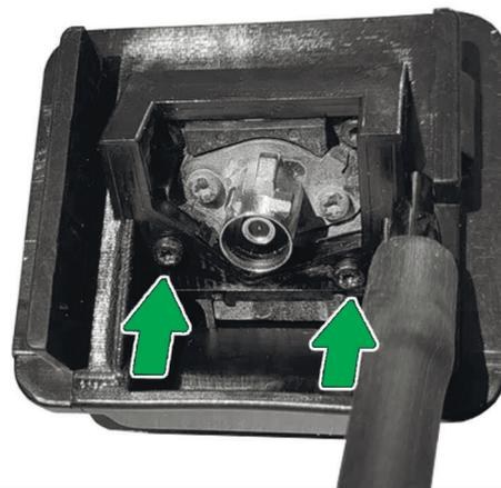
**6** Прорежьте **отверстие** в резиновом уплотнителе проводки камеры. Достаточно сделать надрез 5 мм канцелярским ножом.
