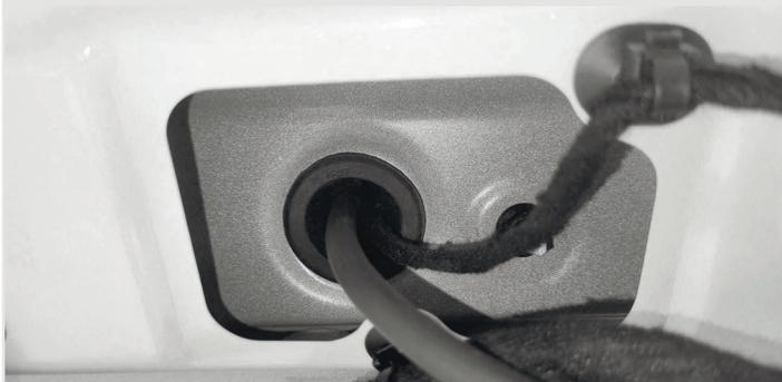
**8** Соедините шланг с обратным клапаном, установите камеру с кронштейном омывателя на штатное место.
