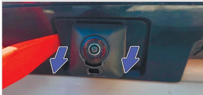
**4** Открутите **2 самореза** TORX6 крепления камеры к штатному кронштейну. Снимите камеру с кронштейна.
